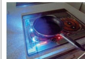
IHクッキングヒーターによる電磁誘導現象の確認実験
